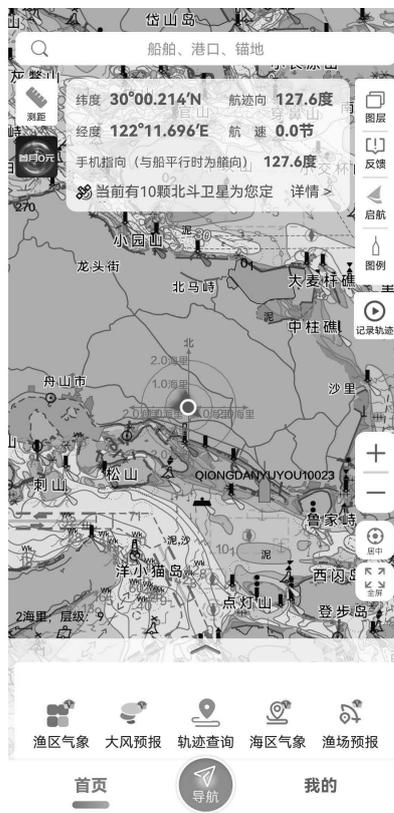
“海e行”是由交通运输部东海航海保障中心联合浙江易航海信息技术有限公司开发的一款整合了海洋资讯查询，提供江海船舶智能助航服务的基于“互联网+”的平台型海洋大数据应用，提供海上智能导助航、水文气象服务、兴趣点收藏、船位查询等丰富功能，助力安全航行。
